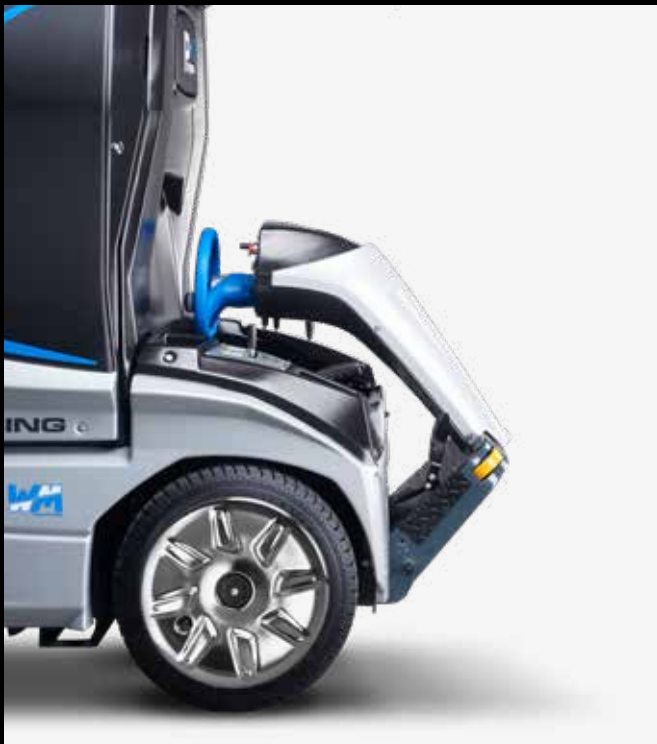
Poste de conduite repliable (2 positions)
