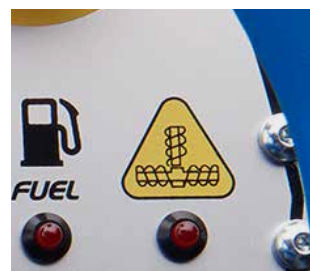
Système d'alarme surcharge des vis sans fin
