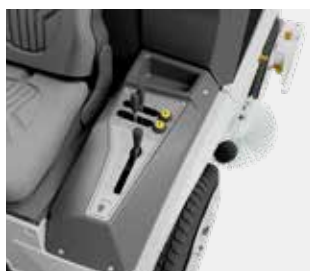
Réglage hydraulique des lames
