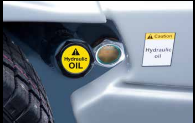
Bonne visibilité : voyant en verre de l'huile hydraulique
